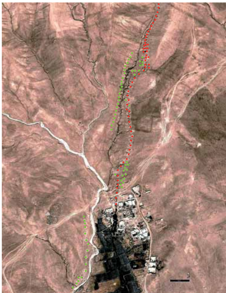
شکل ۲-۱۳: کاريزهای جديد (رنگ سرخ) در جوار کاريزهای خشکيده (رنگ سبز) در قريه دنگرخيل در قلات غلزائي (تصوير: Google Earth، مارچ ۲۰۱۸، تهیه از رفيق پور).
