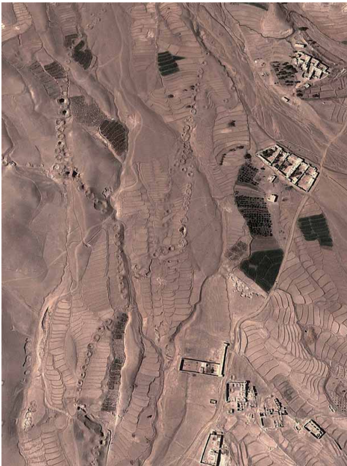
شبکه از کاریزها در منطقهٔ چهل دختران لوگر. در اینجا کاریزها به امتداد دامنه‌ء کوه نظم یافته و برای اهالی این منطقه آب نوشیدنی و آبیاری را تأمین می‌کنند (تصویر: Google Earth، اپریل ۲۰۱۸).
