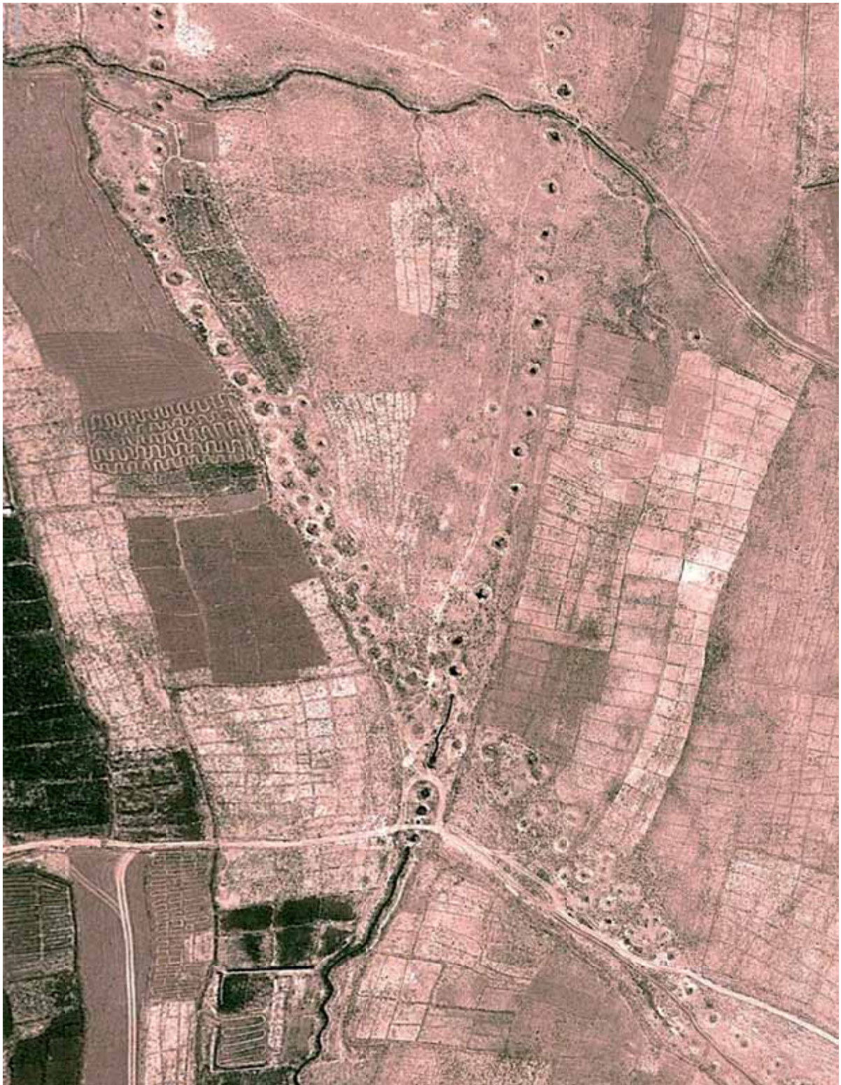
در منطقه پشتون زرغون ولایت هرات در غرب افغانستان از ایام قدیم شبکه متراکم و وسیع از کاریز ها موجود است که تا هنوز نیز فعال بوده و از آنها به منظور تأمین آب نوشیدنی و آبیاری استفاده می شود (تصویر: Google Earth، اپریل سال ۲۰۱۸).
