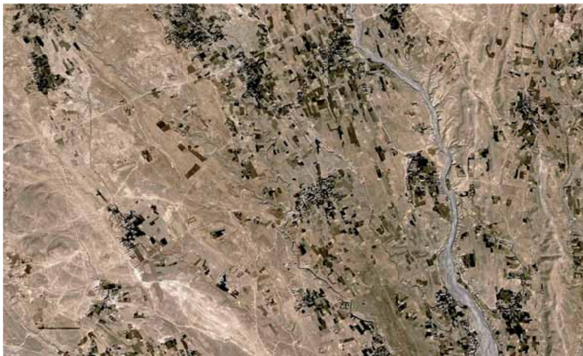
شکل ۲-۱۸: کاریزها در حوالی بند کجکی. در این ساحات از آب رودخانه هلمند در مناطق پائین افتاده و از آب کاریز در بلندیها استفاده می شود (تصویر: Google Earth، مارچ ۲۰۱۸).
